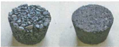
耐油性試験の結果（改質 ii 型（左）とタフアスコン）
