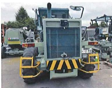
モーターグレーダー後方の上にカメラ付き赤外線センサー、下にミリ波レーダーを搭載している
