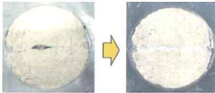
戸田建設は、日本大学工学部と共同で微生物を使った「自己治癒コンクリート」の実用化を目指している。コンクリートに発生したひび割れを微生物の代謝活動を利用して補修する。構造物の機能維持や管理に伴うコスト低減が期待できる。東京都江東区にある自社施設「南砂P」研修センター
