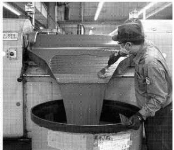
顔料を練り滑らかにする「練肉工程」などを経てインキが完成する(三芳町の本社工場)
