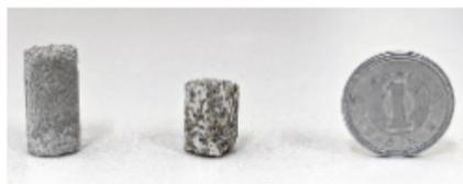
基礎技術を使って製造したCCC。左はセメントペースト、右は珪砂を骨材とした
