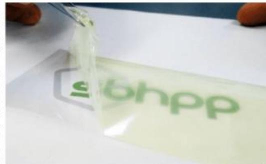
同士を接着するもので、被着体にフェノール樹脂シートを貼り付け、別の被着体を押し付けて熱プレスなどで加熱硬化することで高い耐熱性を持つ接着面が得られる。接着後に250度Cの熱処理を施すと、エポキシ樹脂
