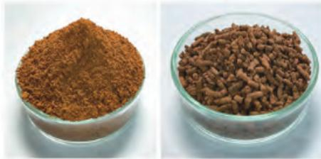
戸田工業が工業生産に取り組むCO<sub>2</sub>固体回収材「ナトリウムフェライト」(左)と「ナトリウムフェライト」(右)のペレット状。
