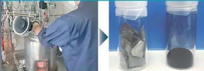
**反応例**  $\text{CO}_2 + \text{酸化カルシウム} (\text{CaO}) \rightarrow \text{炭酸カルシウム} (\text{CaCO}_3) \rightarrow \text{C} (\text{炭素}) \rightarrow \text{黒鉛}$
