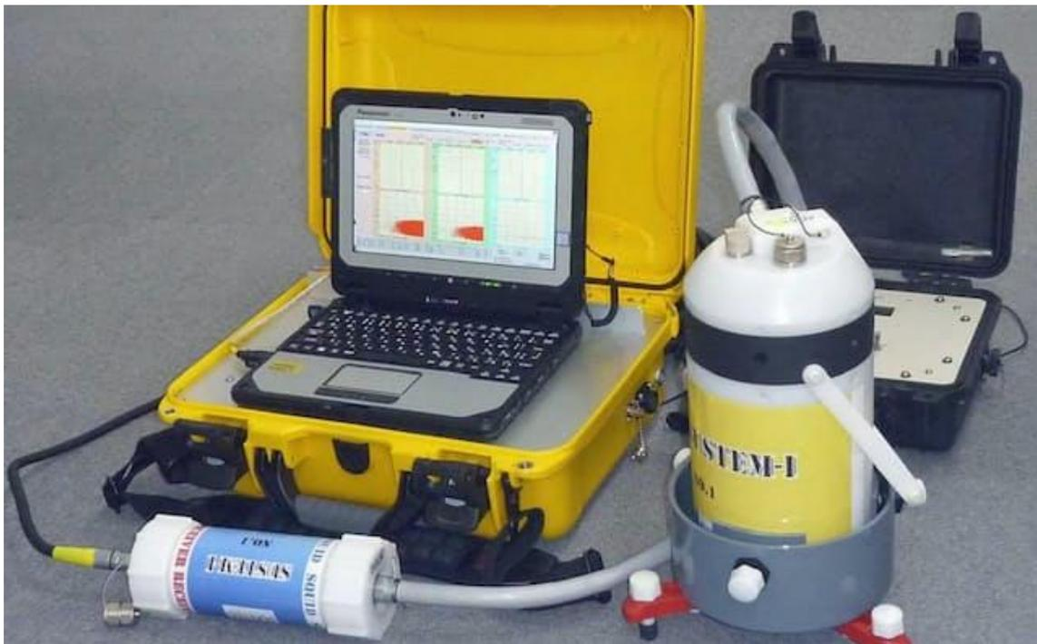
持ち運び可能なペットボトル大の機器⑥で地下の構造を調査する
