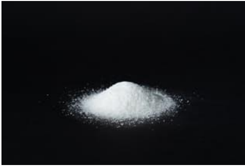
廃 PET を原料に使ったアスファルト改質剤「ニュートラック」
