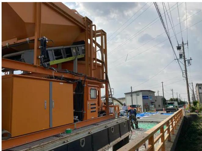
「モバコン」と名付けたプラントは、北陸先端科学技術大学院大学（能美市）や生コン制御システムのハカルプラス（大阪市）などの協力を得て開発した。橋梁に使う超速硬コンクリート、通路などの景観舗装材に用いる瓦コンクリートなど特殊生コンを製造する。
