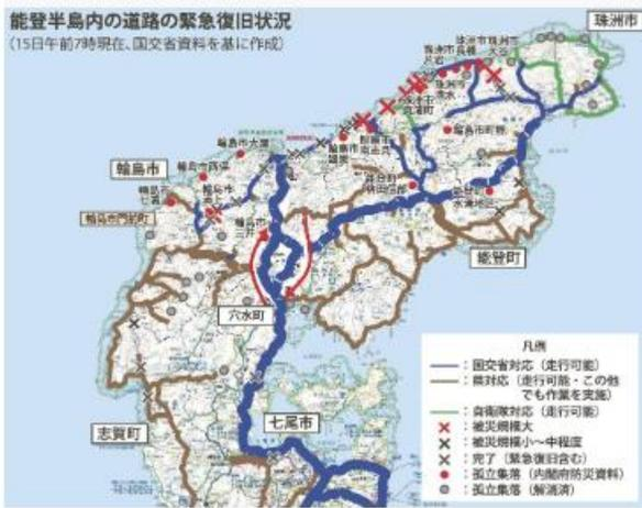
能登半島地震の発生から15日で2週間を迎えた。被害の大きかった沿岸部を中心に多くの孤立集落が点在する中、救援・救助ルートをやや速やかに確保するため、国や自治体、建設業界は発生直後から総力を結集し24時間態勢で「くしの歯」状の道路啓開作業を展開。半島を走る国道249号など主要幹線道路(総延長約300キロ)を対象に、同日午前7時時点で約9割の緊急復旧工事を完了した。くしの歯作戦では大型重機などの資機材搬入で自衛隊の船も活用し、内陸・海側の両方から並行して工事を進めている。
