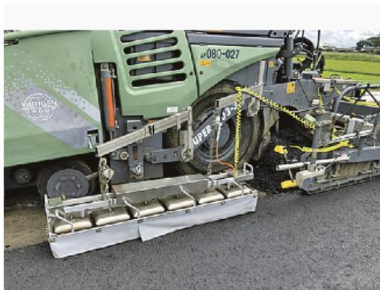
自動点火消火式路面加熱装置「アイジェイヒータ」(報道発表資料から)
