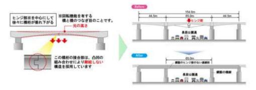
これに対してケーブルによる補強を行なったうえで、必要な調査点検を継続的に実施し、安全に走行できる状態で管理していたが、抜本的な解決には至っていなかった。これらの状況を踏まえ、長期の健全性・耐久性を確保するために、ヒンジ部のない鋼製の連続橋への架替え工事を実施した。
