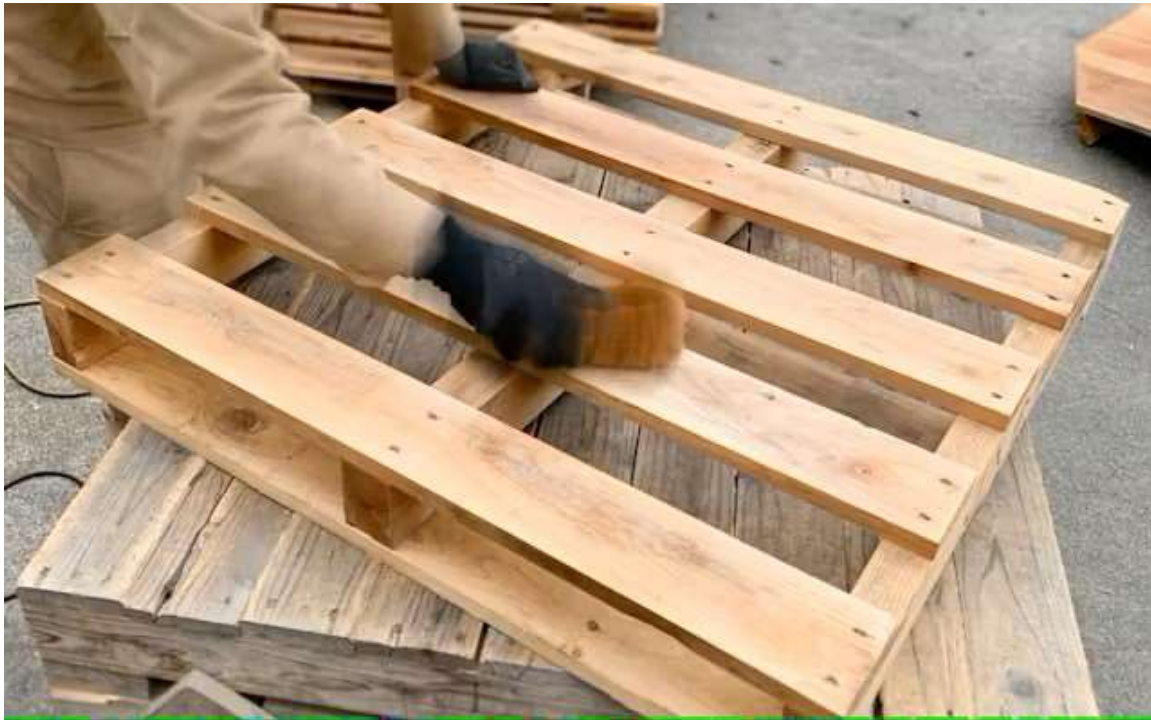
木製パレットを補修して再利用する(JCT 提供)
