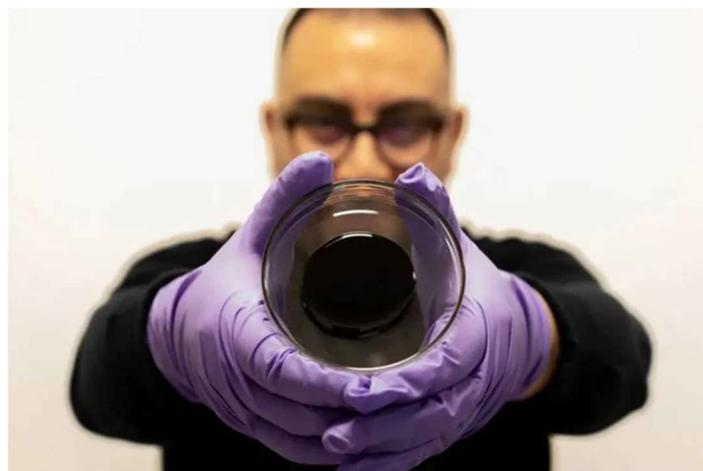
実験室での実験では、自己修復性アスファルト(上の写真でホセ・ノランプエナ=コントレラス博士が手に持っているアスファルト混合物に含まれる粘着性のある黒い物質)は、1 時間以内に表面の微小亀裂を完全に治癒することが示された(画像:スウォンジー大学)
