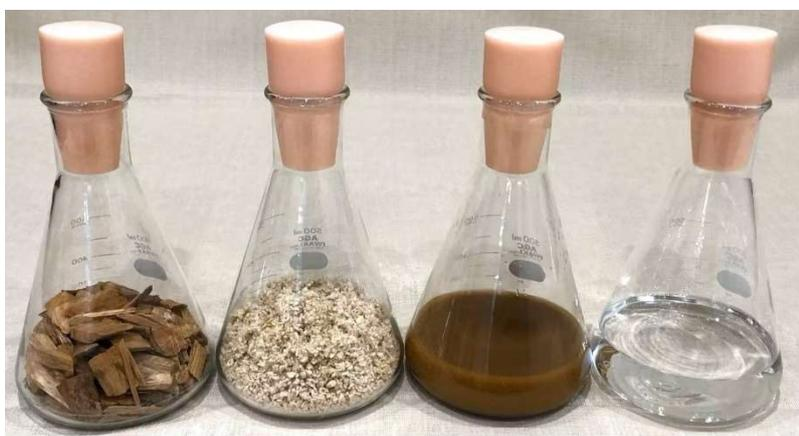
5 社で協力し木材チップ(左端)から製造したバイオエタノール(右端)の事業性を見極める
