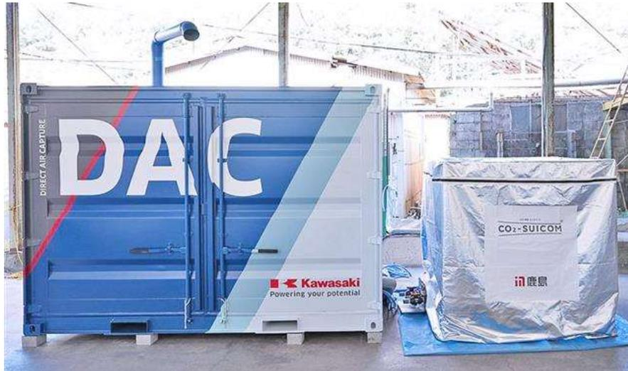
DAC装置(左)と炭酸化養生槽。必要な場所でタイムリーにCO<sub>2</sub>吸収コンクリートが製造できる
