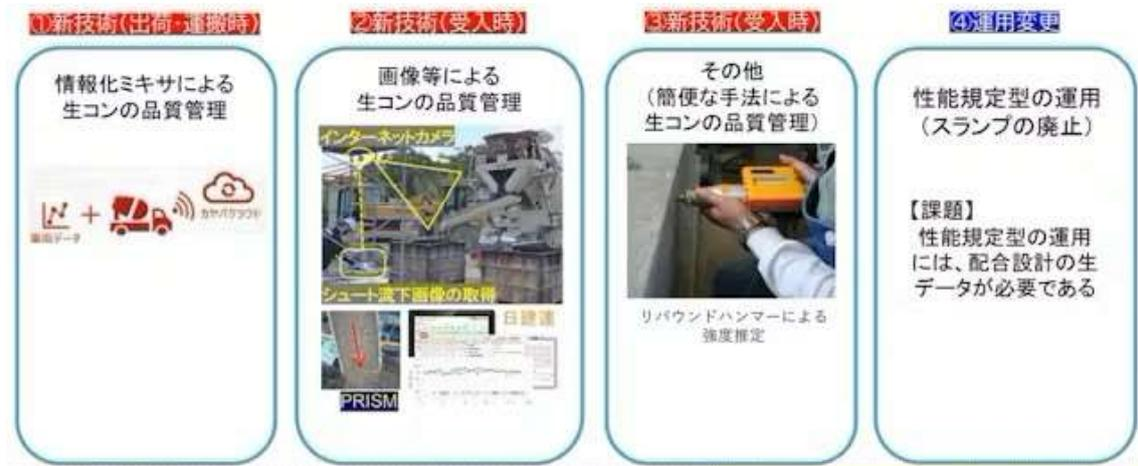
国土交通省がコンクリート品質管理・検査手法を省力化するため導入を目指す手法と運用の変更(出所:国土交通省)
