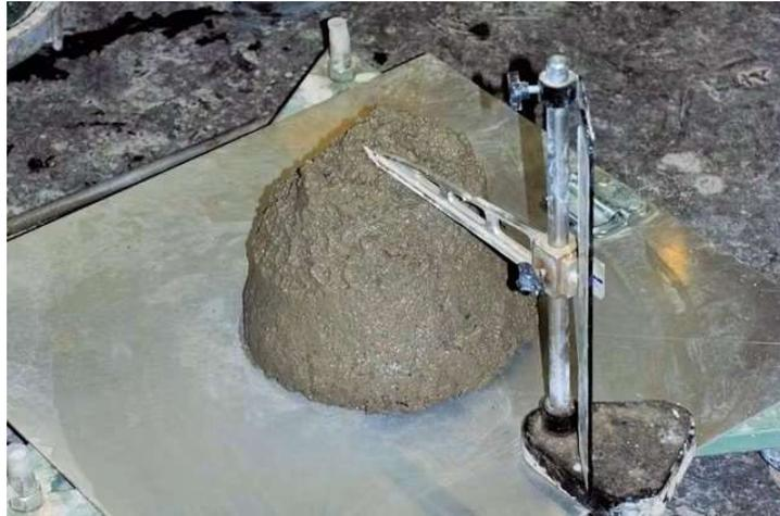
スランプ試験の一例(写真:日経クロステック)
