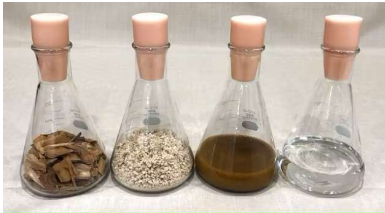
日本製紙は木質チップからバイオエタノールをつくる
