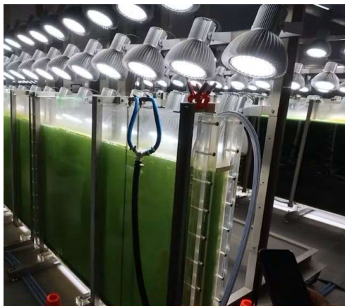
薄い水槽のようなフラットパネル型。側面から光を照射するため、薄くして光の利用効率を高めている。水槽は密閉されておらず、コンタミが起る可能性がある(写真:日経クロステック)
