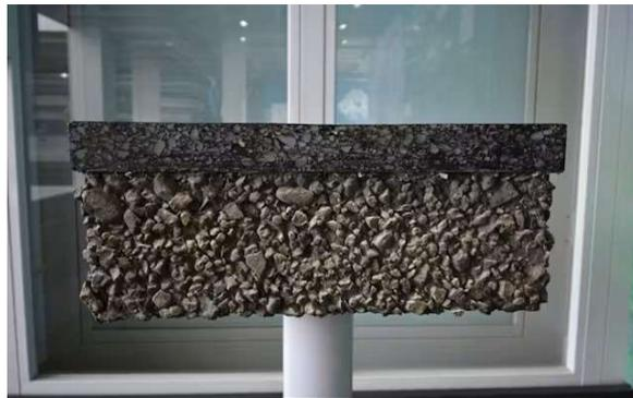
二酸化炭素 (CO2) を固定したアスファルト混合物と路盤材 (写真: 日経クロステック)
