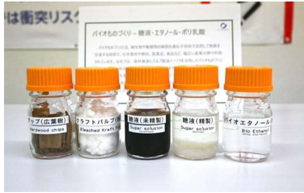
パルプを分解して糖液を抽出しバイオエタノールなどをつくる
