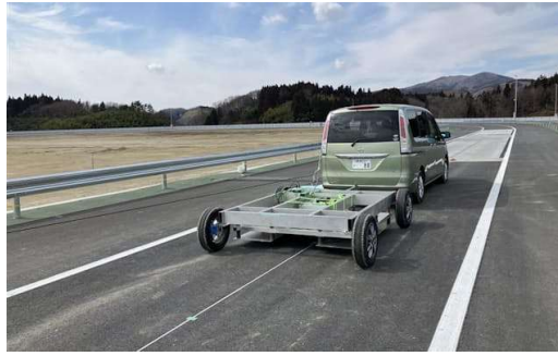
大成建設が福島県内の拠点で実施した無線給電技術の実証実験
