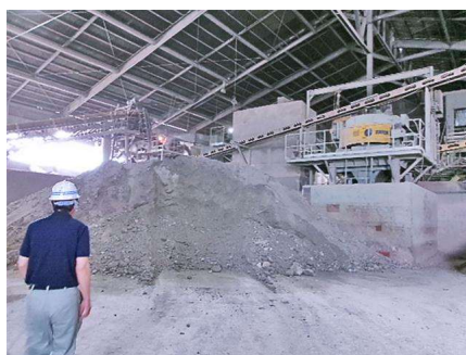
ベントナイト原鉱置き場。1日に約400トンほど置かれる
