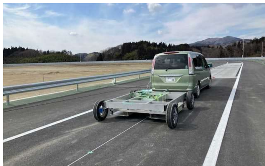
走行中無線給電実験の様子(出所:大成建設)
