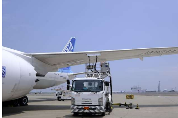
羽田空港で ANA の航空機に国産 SAF を給油する給油車（東京都大田区）
