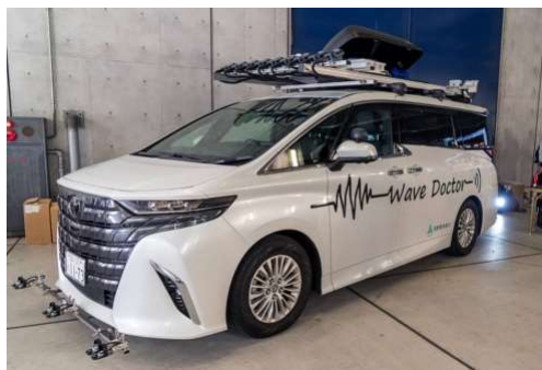
車両前方に照度計、上部に測定用アンテナを備えるウェーブドクター(写真:大上 祐史)
