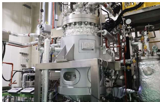
CO 2 原料から生分解性プラスチックを製造する 200 リットル培養槽
