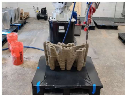
3Dプリント技術で製作される橋の一部/Masoud Akbarzadeh
