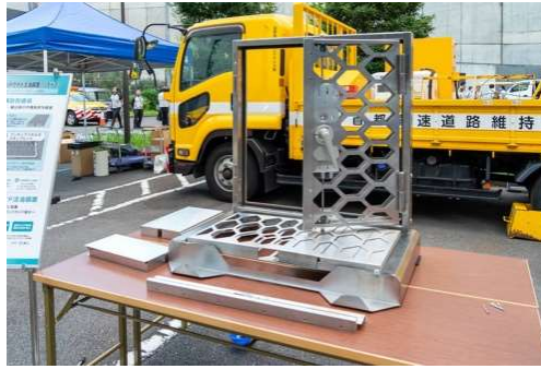
運搬時の形状を小型・軽量化した建具(写真:大上 祐史)
