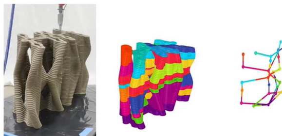
左から右へ: 研究室で3Dプリントされた橋の一部、同じ橋ブロックのコンピューターレンダリング、橋ブロックの荷重支持経路のコンピューターレンダリング。/Courtesy Masoud Akbarzadeh
