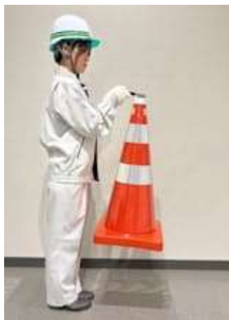
コーンの上部に引っかけて使うことで、簡単に持ち上げることができる
